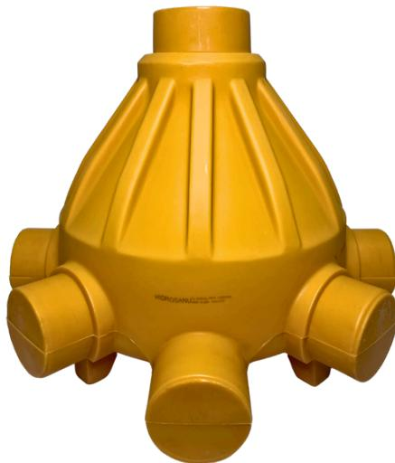
O **TIL RADIAL BBB HIDROSANU** possui cor ocre e é fabricado por meio da rotomoldagem em peça única e sem emendas, sendo extremamente resistente, evitando corrosões, infiltrações, incrustações ou desgastes pelos raios ultravioletas (UV). Devido sua composição em PE, o TIL Radial BBB é leve, fácil de manusear, instalar e realizar manutenções. Não acumula dejetos e gorduras. Não necessita de quebra do pavimento para manutenções.
