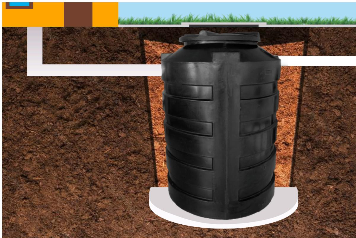
Após a sedimentação, a parte líquida é direcionada para o Filtro Anaeróbio, no material filtrante, forma-se um biofilme adsorvido, que nada mais é que uma camada de microrganismos que realizarão a decomposição da matéria orgânica. O processo de tratamento é um processo biológico realizado pela ação de microrganismos. Após a filtração o efluente tratado é direcionado ao meio de descarte final. (Consultar o Órgão Ambiental Municipal).
