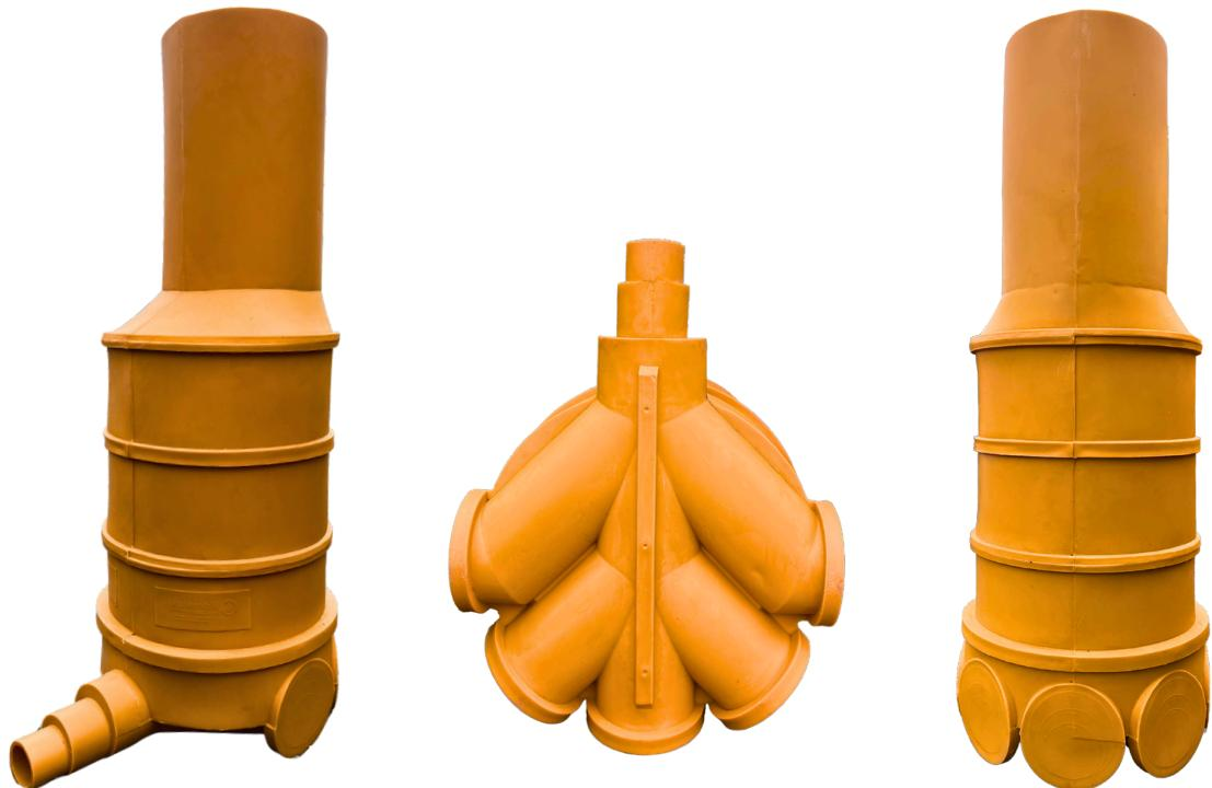
O PV - Poço de Visita HIDROSANU é produzido por meio da rotomoldagem em peça única, porém, pode ser prolongado com prolongadores de 500 mm. Devido sua composição em PE, o poço é leve, fácil de manusear, instalar e realizar manutenções. O material é extremamente resistente, evitando corrosões, infiltrações, incrustações ou desgastes pelos raios ultravioletas (UV).
