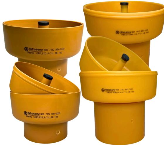
O **TAMPÃO PARA TIL HIDROSANU** possui cor ocre e é fabricado por meio da rotomoldagem em peça única e sem emendas. Contém tampa de borracha EPDM (resistente a intempéries), que vedá, não quebra e não adere ao concreto. Conta ainda com uma trava linear, que aumenta a segurança contra a abertura involuntária da tampa.
